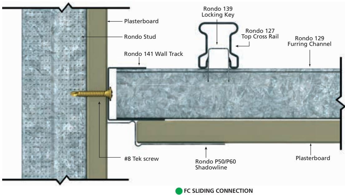
■ KEY-LOCK® SLIDING PERIMETER CONNECTION DETAIL
