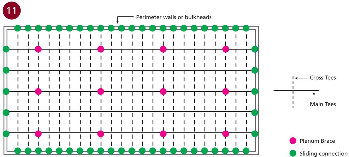
■ DUO® CEILING PLAN - TYPICAL PLENUM BRACING ARRANGEMENT
