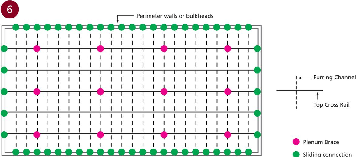
KEY-LOCK® CEILING PLAN – TYPICAL PLENUM BRACING ARRANGEMENT
